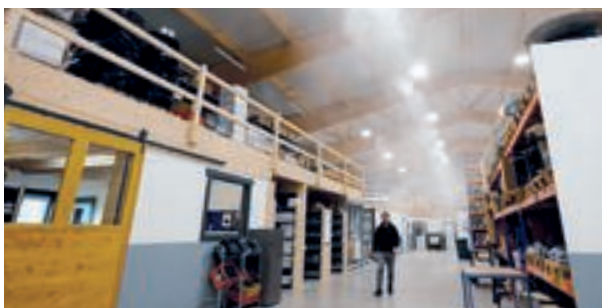
In der Produktionshalle werden die Systeme in Eigenfertigung produziert, unterstützt durch das Hochdruckvernebelungssystem, das für effektive Staubbindung und ein angenehmes Arbeitsklima sorgt.
